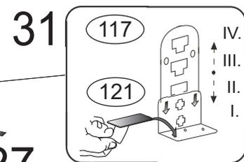
Nasadte varifix č.117. Slouží jako podpora lamelového roštu. Mezi rošt a varifix vlepte filc č.121
